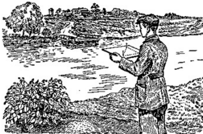
Figura 25. Medición de la anchura de un río con el instrumento de alfileres
