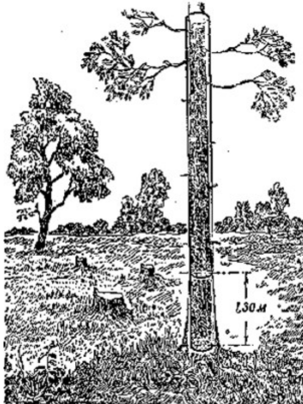
Figura 21. Los números muestran que parte del volumen del árbol medido equivale al volumen de un cilindro de la misma altura, cuyo diámetro se mide a la altura del pecho de una persona, 1,30 m. (Resulta conveniente efectuar la medición a esta altura).
